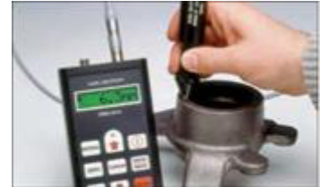
在狭小区域对普通裂纹的测量
